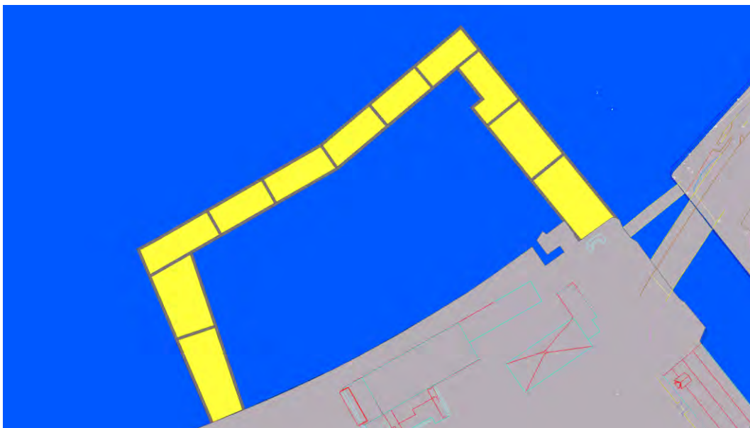
Figur 71. Spontkofferdamen är sluten
