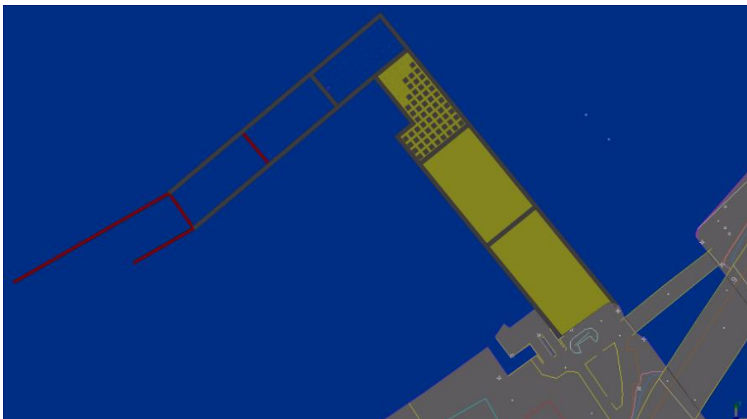
Figur 67. Sedan pålplattor eller ett lastfördelande sandlager lagts ut över pålskallarna fortsätter fyllningen av cellerna i torrhet
