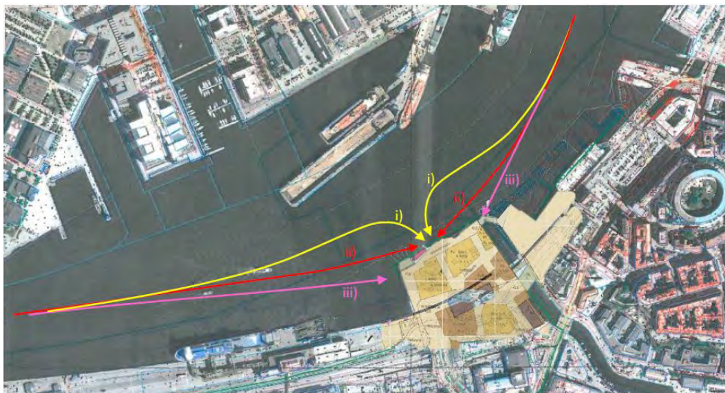
Figur 12. Exempel på hur de tre huvudsakliga feltyperna kan leda till påsegling av Järnvågen på olika platser och under olika vinkel mot kajlinjen för uppströmsgående och för nedströmsgående trafik. (obs – GC-brons utformning är inte den gällande)
