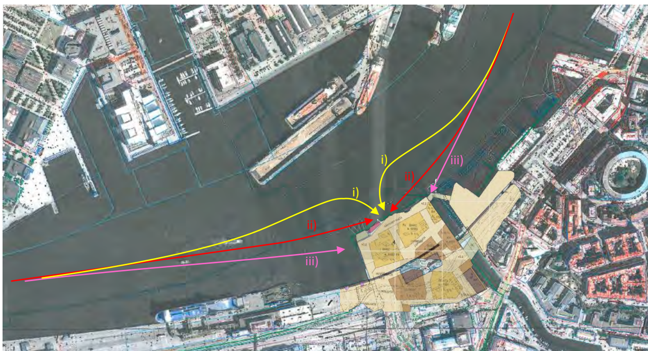
Figur 4.1. Exempel på hur de tre huvudsakliga feltyperna kan leda till påsegling av Järnvågen på olika platser och under olika vinkel mot kajlinjen för uppströmsgående och för nedströmsgående trafik.
