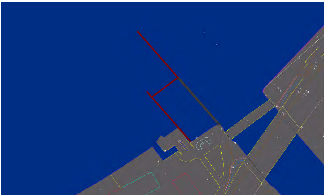
Figur 63. En tvärvägg av spont slås mellan de båda parallella spontväggarna. Härigenom skapas en tät cell. Inom den täta spontcellen får bankpålning utföras.
