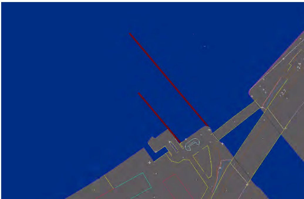
Figur 62. Då fronten på spontningsarbetena för den yttre sponten hunnit ett stycke, påbörjas en parallell front med slagning av den inre sponten
