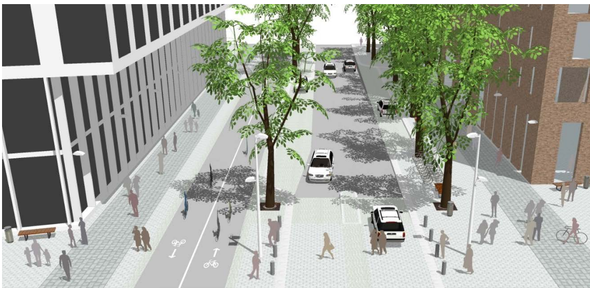
Föreslagen sektion för Emigrantsvägen. Bredden är på totalt cirka 26 meter. Bilden är ett exempel på hur gatan skulle kunna utformas, möjligheten för att placera träd i gatan utreds.
