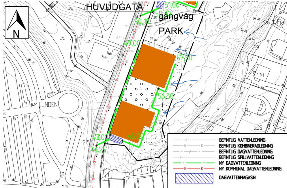
Figur 6. Skiss på dagvattenhantering inom delområde 3. Möjlig placering av underjordiska magasin är markerat med blått och avledningsprincip med grönt. Gröna siffror visar föreslagna vattengångar.
