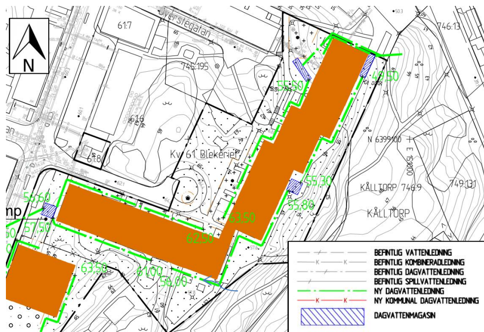
Figur 4. Skiss på dagvattenhantering inom delområde 1. Möjlig placering av underjordiska magasin är markerat med blått och avledningsprincip med grönt. Gröna siffror visar föreslagna vattengångar.
