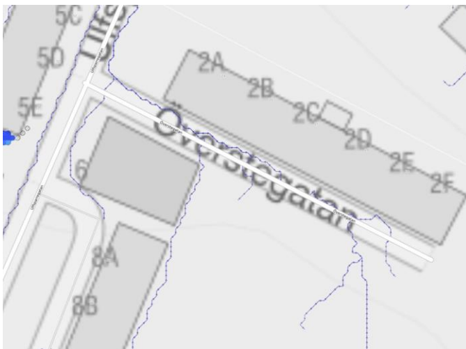
Figur 9. Resultat från lågpunktskartering med befintliga rinnvägar. Modellen har belastats med 70 mm regn. Ingen större vattensamling uppstår inom planområdet.
