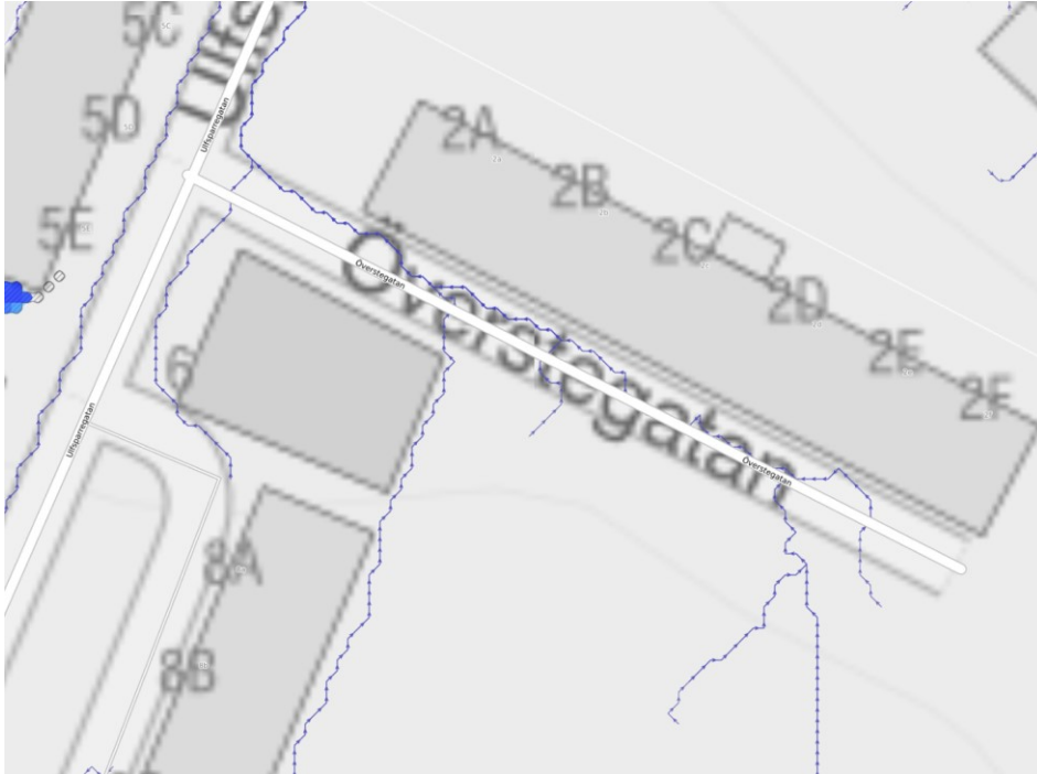
Figur 6 Resultat från lågpunktskartering i Scalgo med befintliga rinnvägar. Modellen har belastats med 70mm regn. Ingen större vattensamling uppstår inom planområdet.
