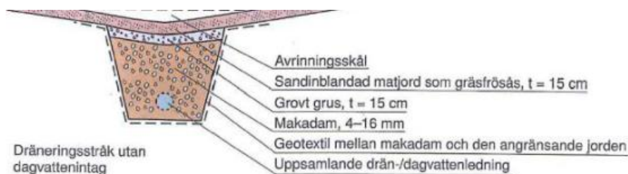
Figur 24. Skiss över stenkista av typen dikesmagasin (Svenskt Vatten P104).
