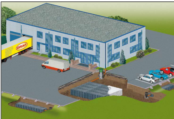
Figur 8. Exempel på utjämningsmagasin bestående av dagvattenkassetter. Illustration: Uponor
