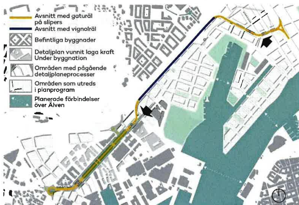
Redovisning av typ av räl utmed sträckans olika delar (PM Gestaltungsprinciper, Afry). Pilar visar vy från vilken bilder och visionsbilder på sid.59, 60 och 61 är tagna.
