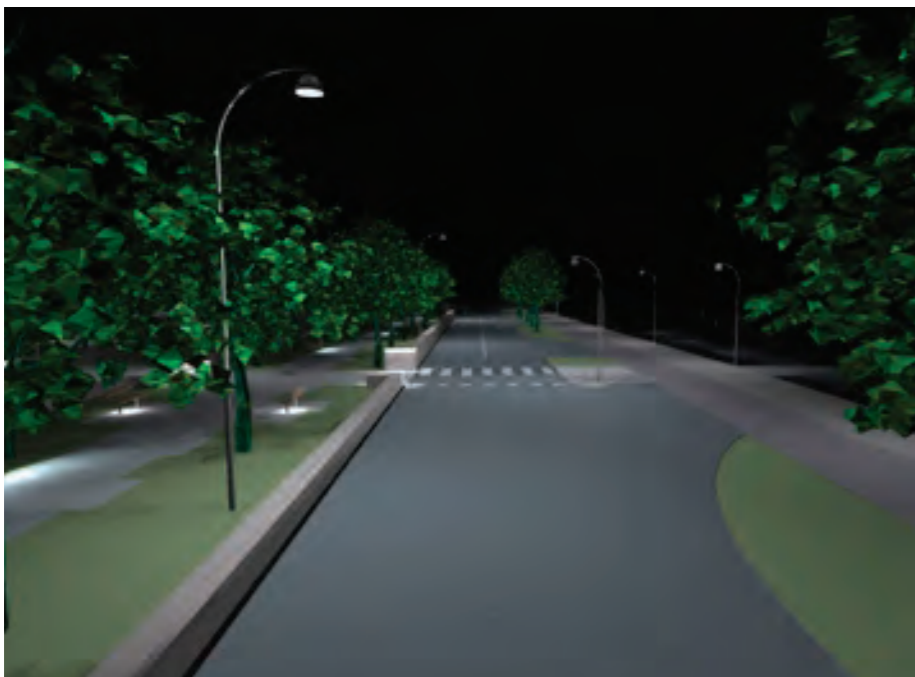
Vy längs gata från belysningsberäkning. Gatuarmatur på 8m stolpe belyser gata och gatuarmatur på 5m stolpe belyser GC-väg. En kompletterande belysningsstolpe placeras framför övergångsställen.
