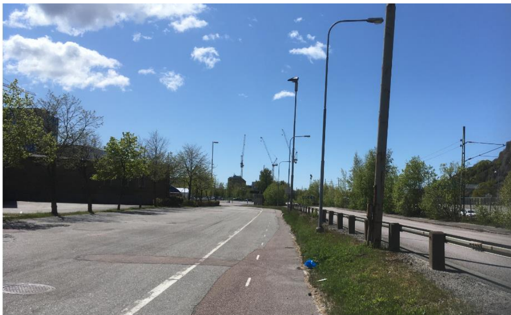
Figur 10 Gångbana saknas och cykelbanan är endast avskild med vägmarkering på del av Lundby Hamngata.
