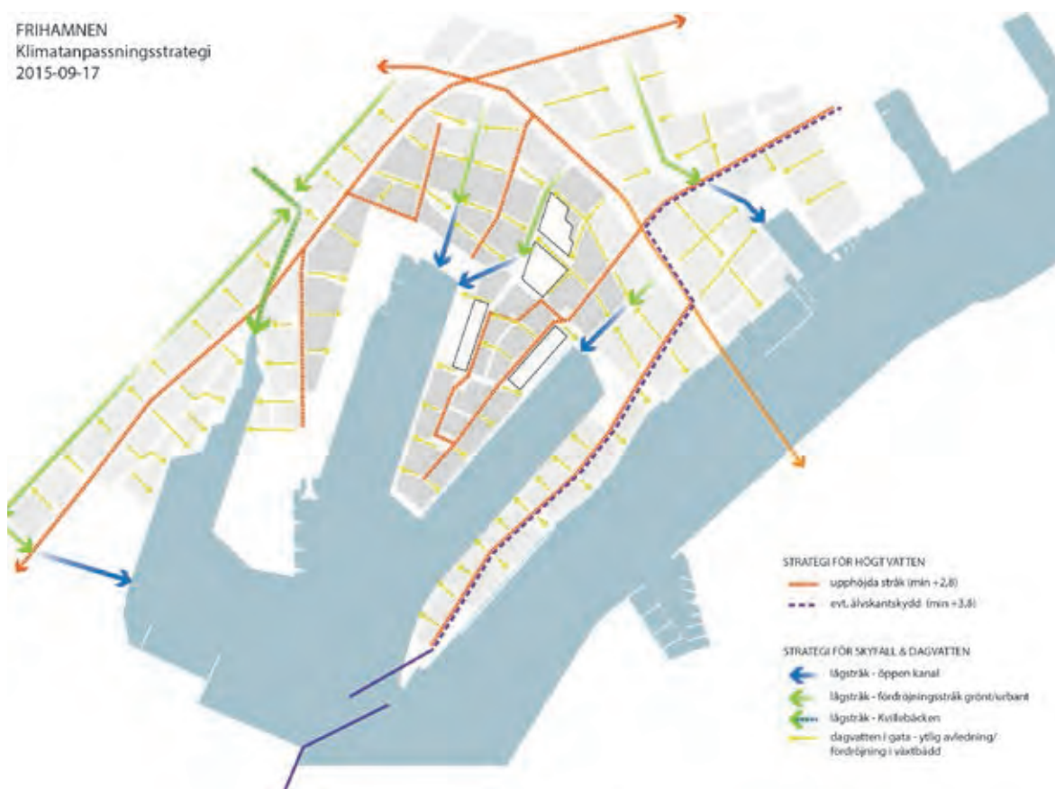
Figur 22. Översiktskarta som visar principen med hög- och lågstråk, samt de olika typerna av lågstråk som samverkar för att ta hand om allt från fördröjning av 10 års regn till de stora flödena vid 100 årsregn.
