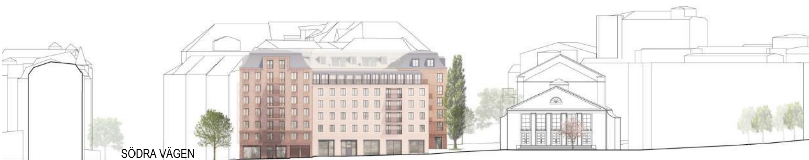
Fasad mot Lorensbergsteatern som visar tillkommande bebyggelses relation till omgivande bebyggelse och hur utformning och höjd anpassats till teatern, poppeln och övrig bebyggelse inom kvarteret.
