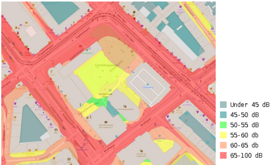
Karta som visar befintlig bullerutbredning (ekvivalent ljudtrycksnivå) i kvarteret. Beräknat på 2021 års trafikdata. Källa: GotMap (goteborg.se)
