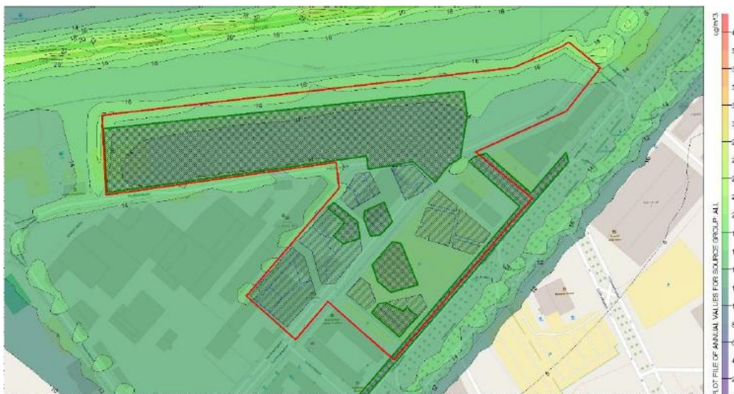
Framtida scenario 2035, beräknade halter av kvävedioxid som årsmedelvärden, med Hamnbana och Lundbyled. De högst beräknade halterna innanför planområdets norra och södra delar ligger på omkring 16 ug/m 3 respektive 12 ug/m 3 . Värdena ska jämföras mot miljö kvalitetsnormens gränsvärde på 40 ug/m 3 . Miljö kvalitetsmålet Frisk Luft för kvävedioxid ligger på 20 ug/m 3
