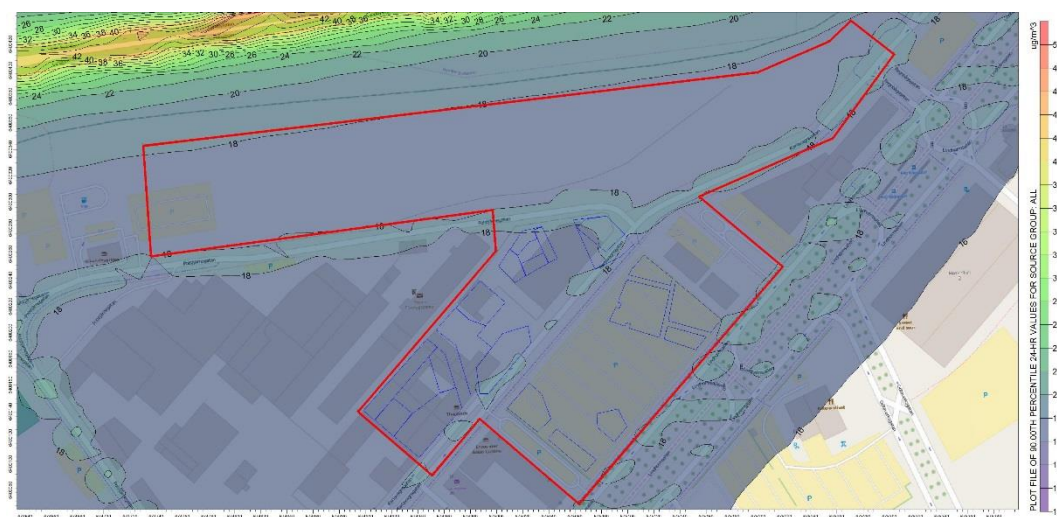
Figur 19. Nuvarande situation 2013/2015, beräknade halter av partiklar (PM 10 ) som dygnsmedelvärden. Planområdet markeras med röd linje och föreslagna byggnader med blå.
