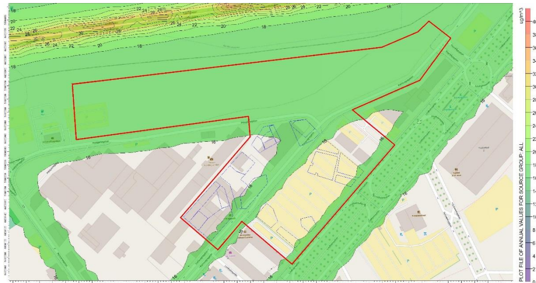
Figur 15. Nuvarande situation 2013/2015, beräknade halter av partiklar (PM 10 ) som årsmedelvärden. Planområdet markeras med röd linje och föreslagna byggnader med blå.
