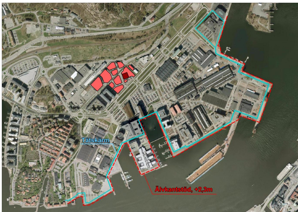
Figur 5 Föreslagen sträckning av högvattenskydd (SBK, oktober 2016).
