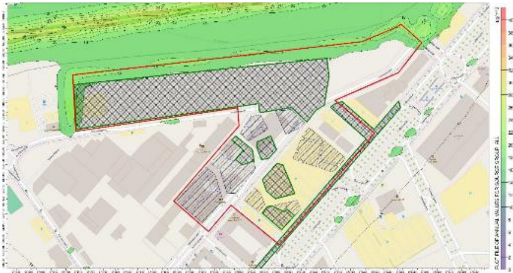
Figur 21 Beräknade halter av partiklar (PM 10 ) som årsmedelvärden. Utredningsområdet markerat med röd linje.
