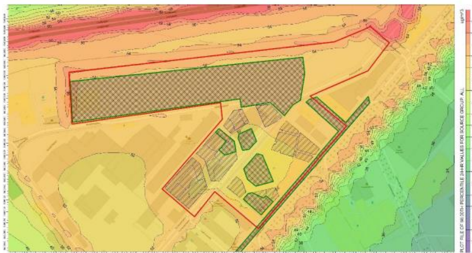
Figur 14 Framtida scenarion 2020. Beräknade halter av kvävedioxid som dygnsmedelvärden. Utredningsområdet markerat med röd linje.
