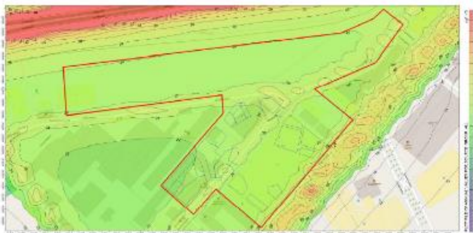
Figur 10 Nuvarande situation 2013/2015. Beräknade halter av kvävedioxid som årsmedelvärden. Utredningsområdet markerat med röd linje
