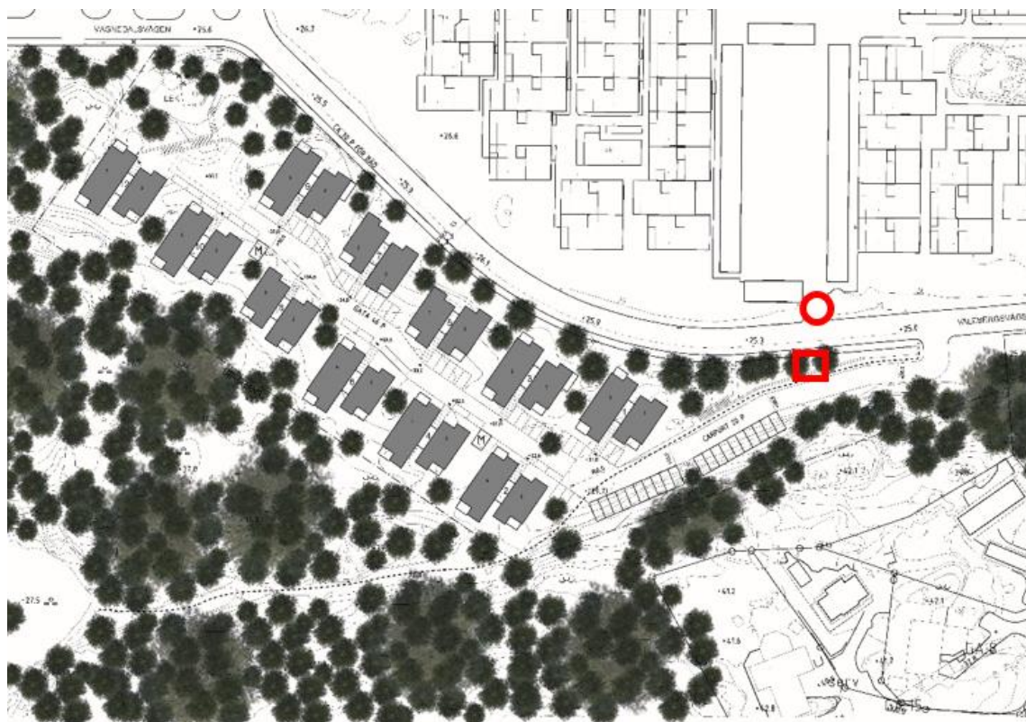
Figur 9. Röd ruta visar föreslagen placering av magasin. Röd cirkel visar anslutningspunkt till befintligt ledningsnät.
