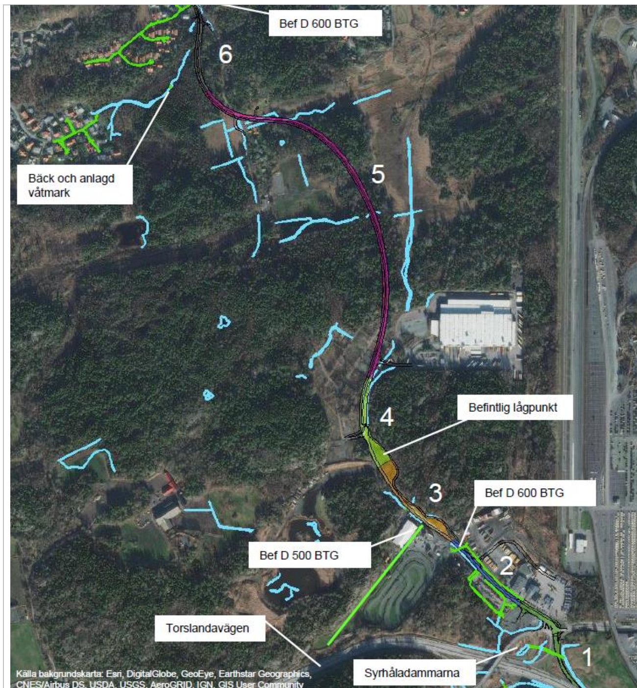
6.5:1 Befintliga delavrinningsområden (delsträckor) från ytan som planeras för Torslanda tvärförbindelse och befintliga dagvattensystem. Bäcker och diken är markerade med ljusblå linjer och befintliga dagvattenledningar är gröna.
