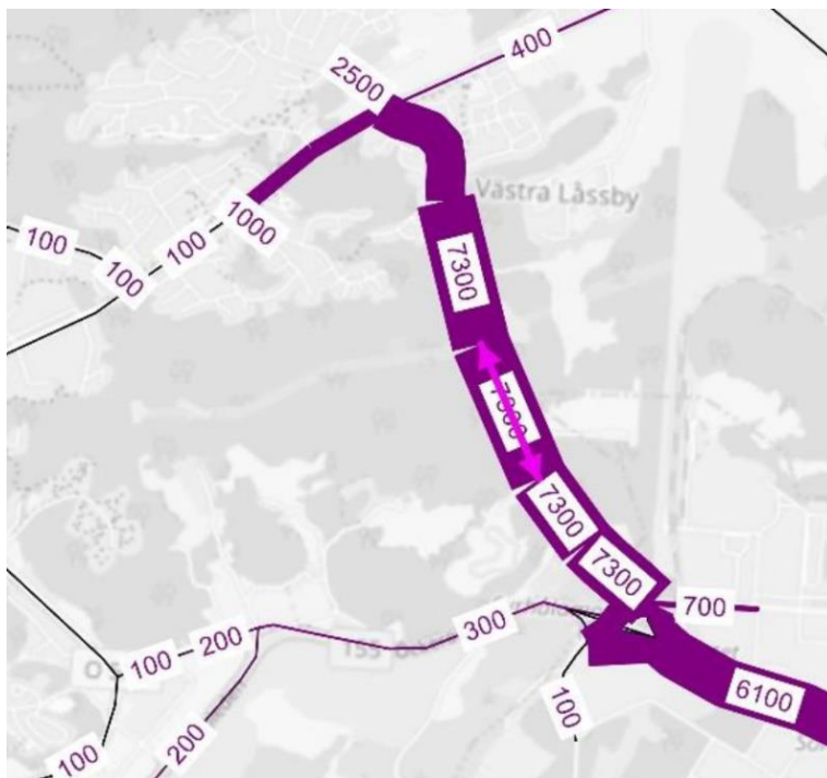
F.2:2 Ursprung för de trafikströmmar som bedöms utnyttja tvärförbindelsen, år 2030, hög prognos.
