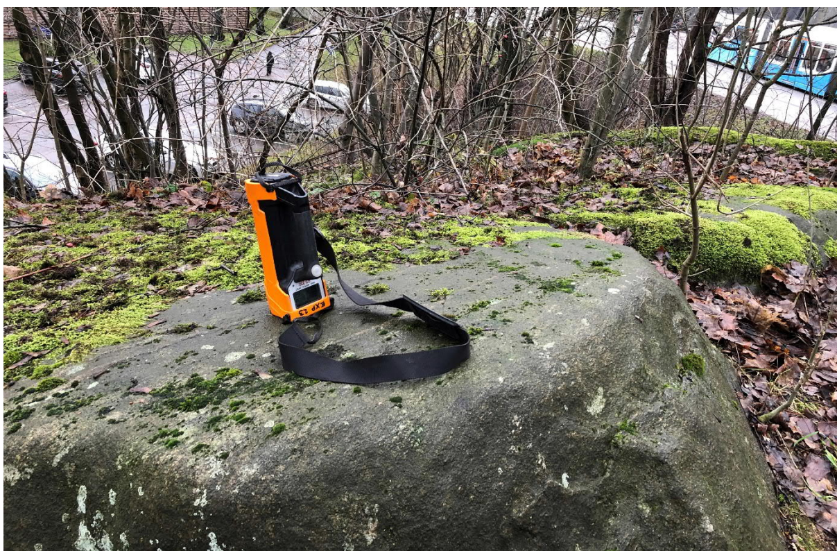
Figur 12 Mätning med gammaspektrometer
