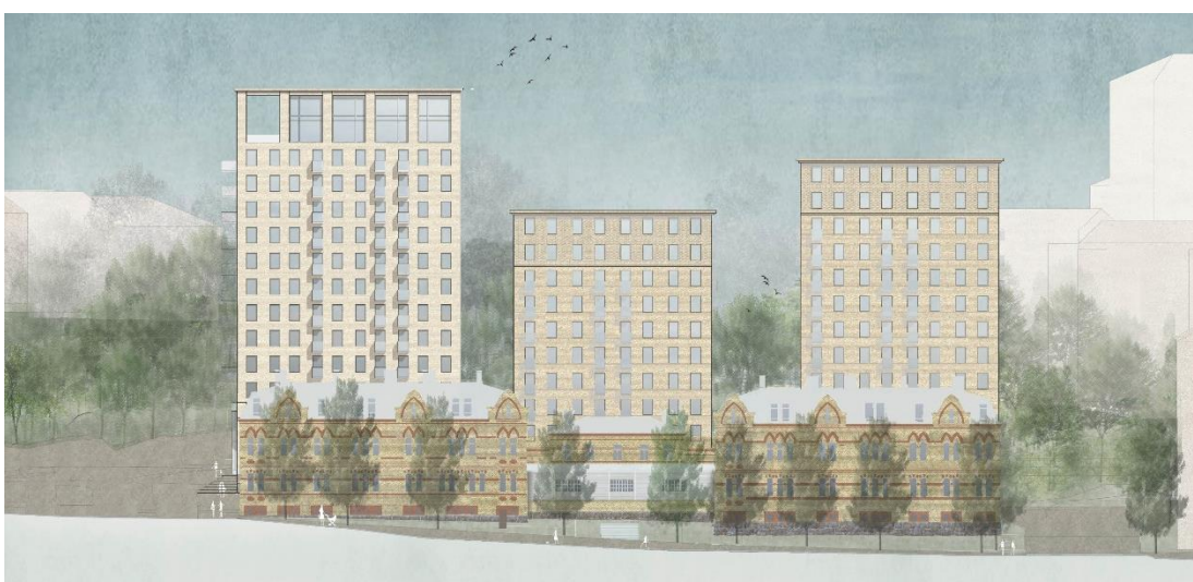
Fasad mot öst. Högsta punkthuset är placerat mot Chalmers hållplats medan de två övriga punkthusen trappas upp mot Norra Guldheden. (Liljewall arkitekter)
