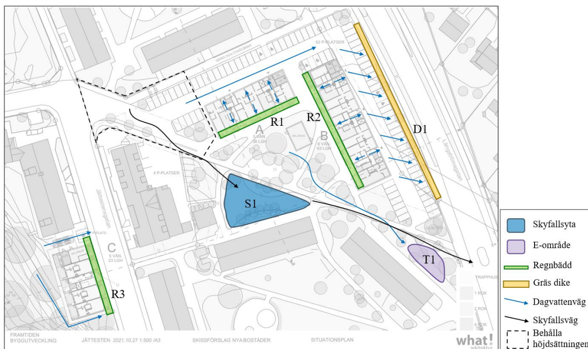
Figur 15 Förslagen åtgärder för dagvatten- och skyfallshantering.
