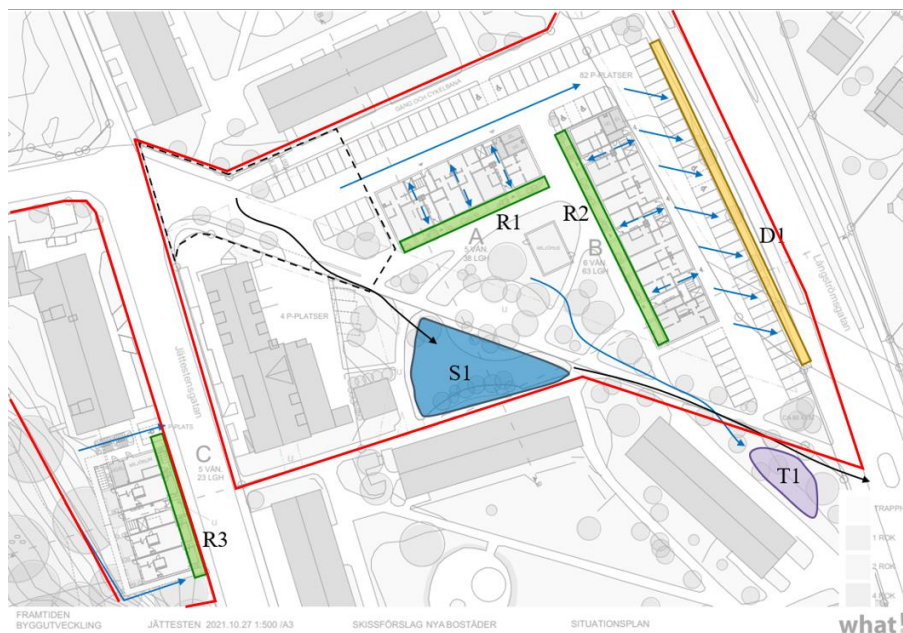
Bild A Åtgärdsförslag för dagvatten- och skyfallshantering. Röd linjen markerar ungefärlig planområdesgräns.
