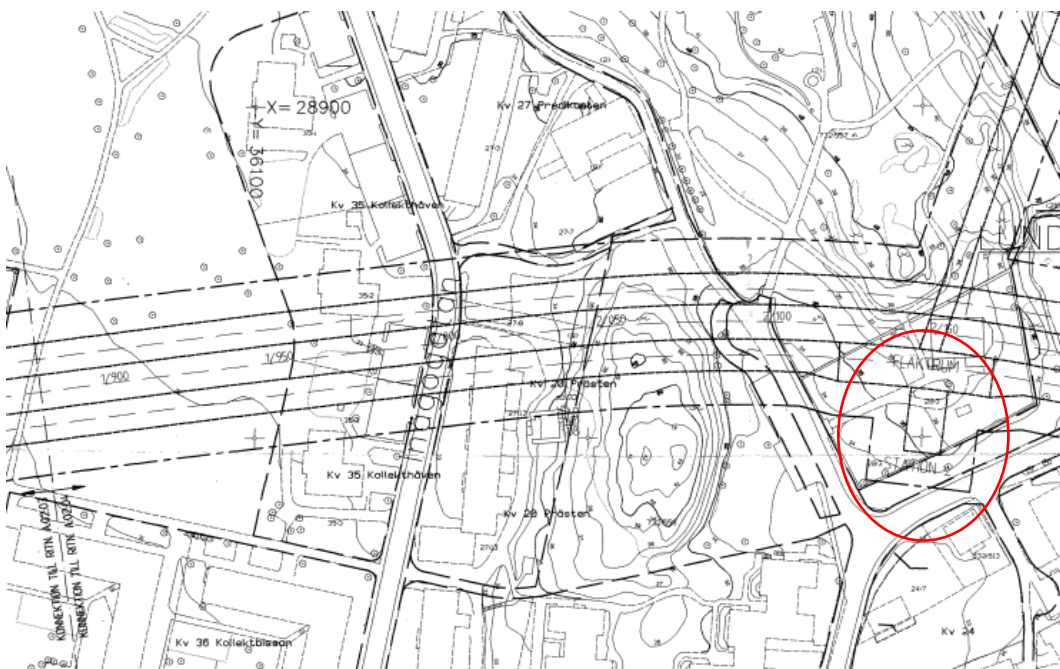
Figur 3 Planritning Lundbytunneln visande fläktrum på ca 180 meters avstånd från planområdet. Flera befintliga bostäder ligger på avsevärt närmare avstånd
