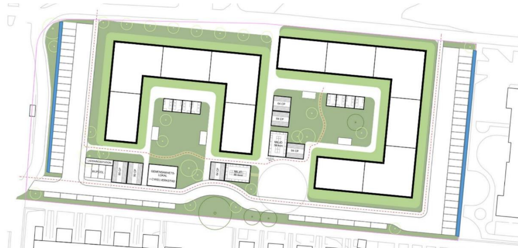
Schematisk utplacering och ytanspråk för dagvattenhantering via makadamdiken (utritade i blått i figur).
