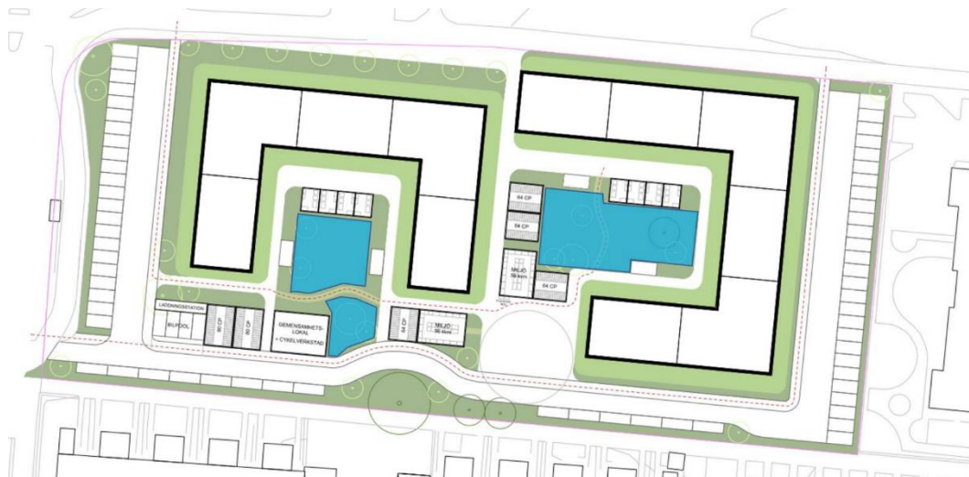
Schematisk utplacering och ytanspråk för dagvattenhantering via översilningsytor (utritade i blått i figur)
