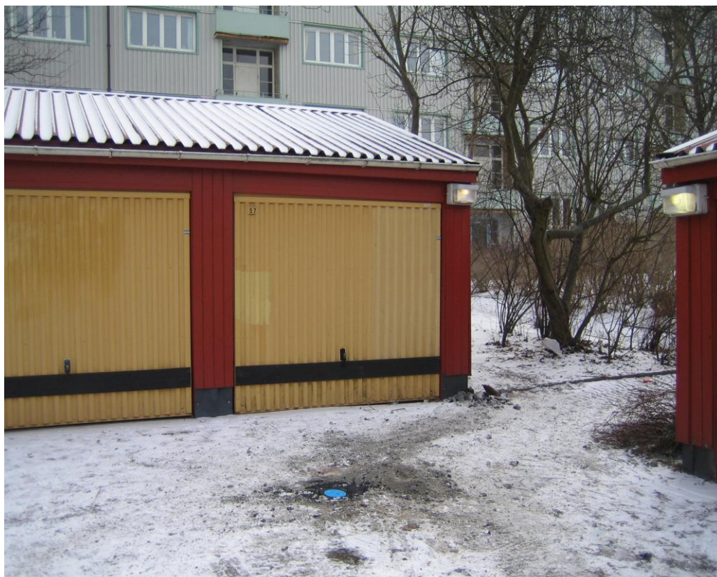
Borrhål 1 (BH1) i fastigheten Kungsladugård 21:26 med garagelängor och bostadshus i bakgrunden. I BH1 installerades ett grundvattenrör som försågs med dexel, vilket kan ses som en blå ring i asfalten.
