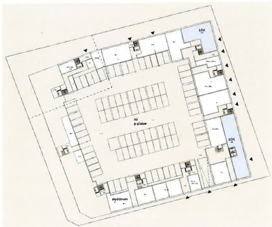
Figur 46: En möjlig utformning av garageplan som visar hur bilparkeringsplatser kan anordnas i garage under mark. Möjligt läge för garagenedfart syns längst söder i bild mot Katrinedalsgatan. Bild: Krook & Tjäder.
