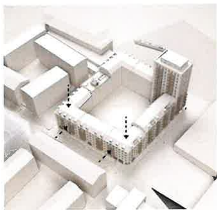
Figur 15: Konceptbild som visar hur det nya kvarterets skala förhåller sig till omgivningen med nedtrappade volymer mot befintlig bebyggelse längs Ebbe Lieberathsgatan. Bild: Krook & Tjäder.
