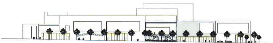
Illustration av vattenparkens fasad utmed Mölndalsvägen med lokaler för centrumändamål jämt fördelade i entrévåningen samt en fickpark i mitten som delar in fasaden i mindre enheter (Wingårdhs, Liseberg 2018-10-15)
