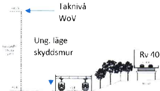
Till vänster Sektion över föreslaget läge på skyddsmur mot avåkande tåg samt till höger foto på liknande skyddsmur utmed järnväg söderut inom f.d. Lyckholms fabriker.
