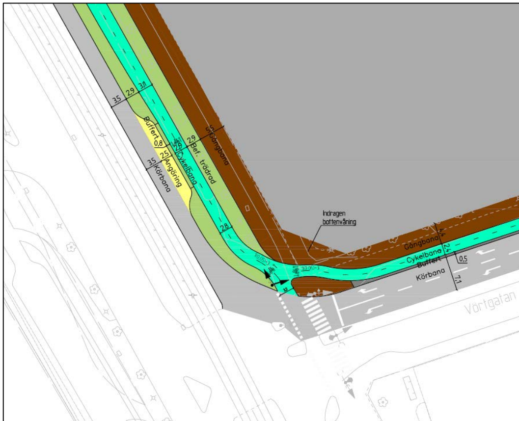
Figur 6 Trafikförslagets anslutning till befintlig korsning i söder.
