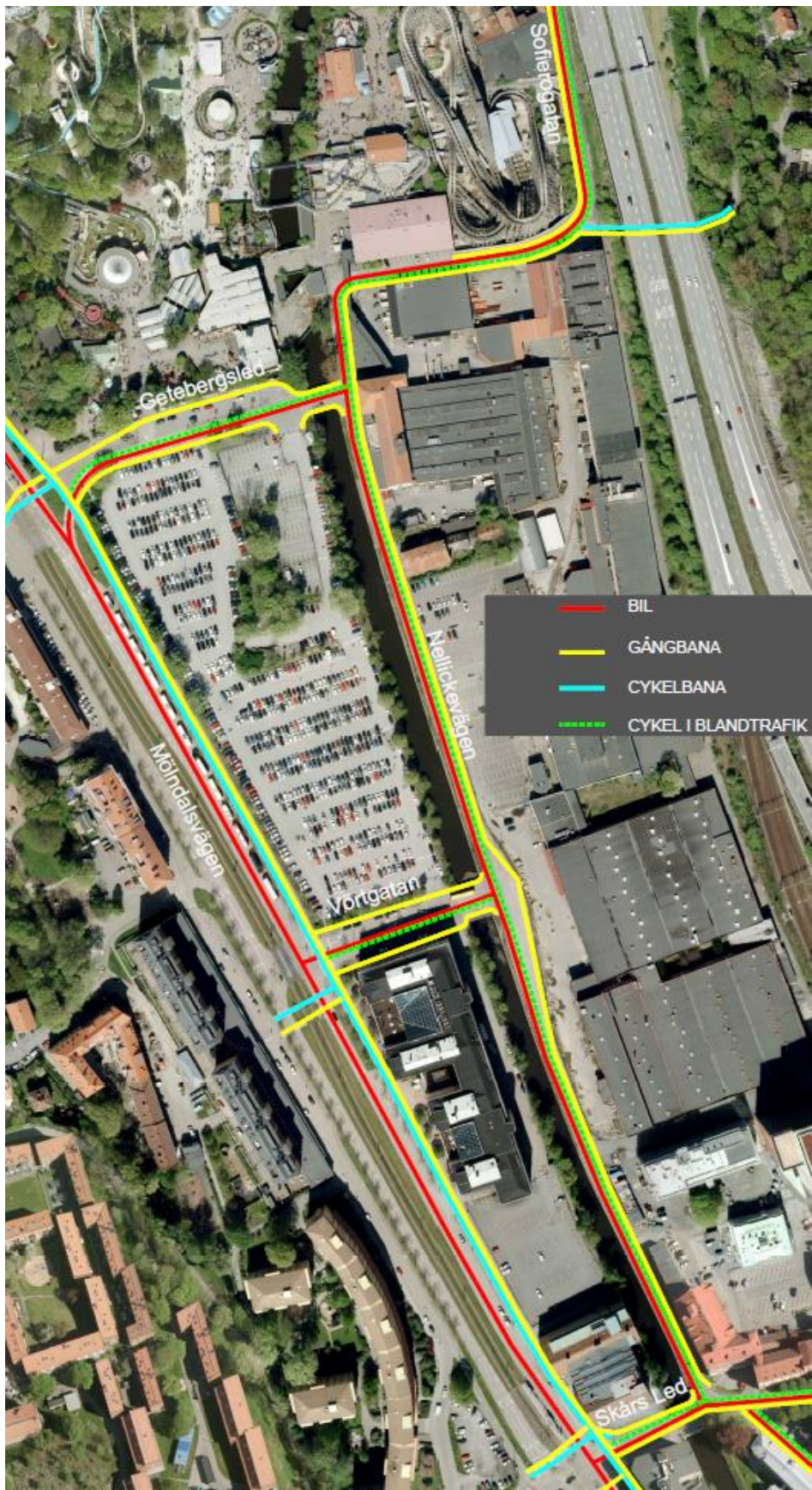
Figur 4 Översiktligt befintligt trafiksystem
