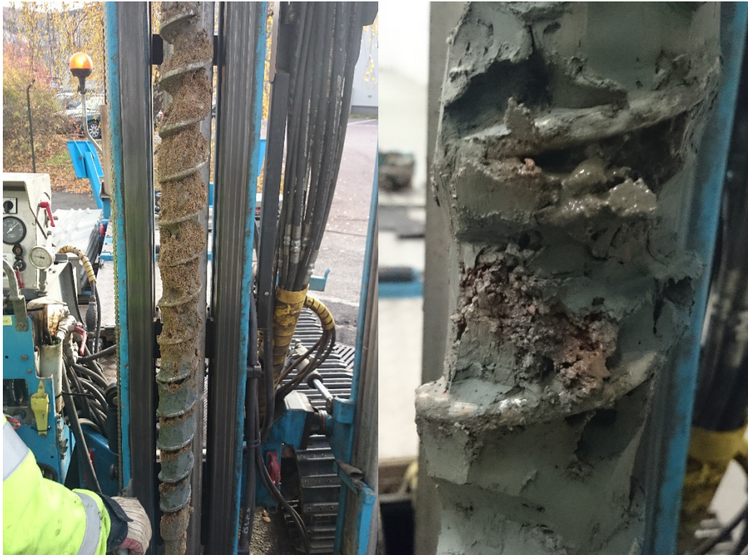
Figur 7. Till vänster syns sandiga grusiga fyllnadsmassor från provpunkt 5 och till höger syns tegelrester från provpunkt 2.
