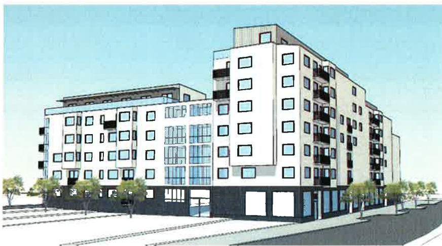
Alternativ med fristående huskroppar sammanbyggda i fasad med inglasade balkonger, sett från Mölndalsvägen
