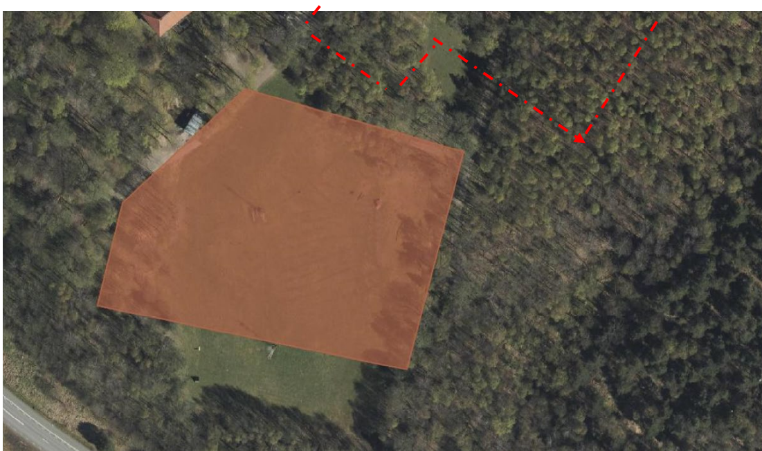
Flygfoto med ungefärlig utbredning av nedlagd deponi. Gräns för markarbeten ungefärligt markerad med röda punktstreck.
