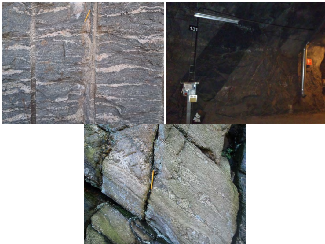
Figur 2. Förekommande bergarter: överst till vänster grå till rödgrå bandad slirig gnejs; överst höger 1,5 m bred amfibolitgång som är parallell med foliationen; längst ner kvartssliror i gnejs.
