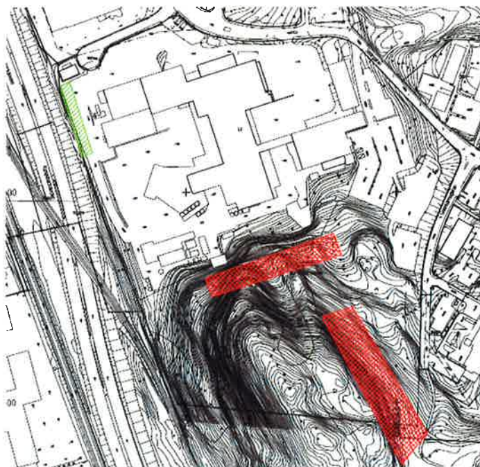
I de röda skrafferade områdena, krävs bergtekniska åtgärder. I området med grön skraffering föreslås lastrestriktion och stabilitetshöjande åtgärder.
