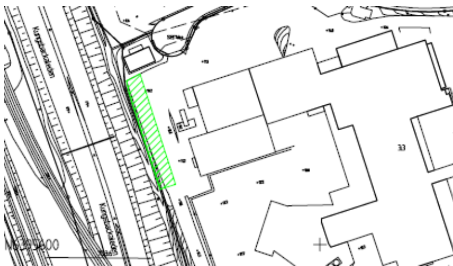
Figur 16 Område med lastrestriktion och avlastning.
