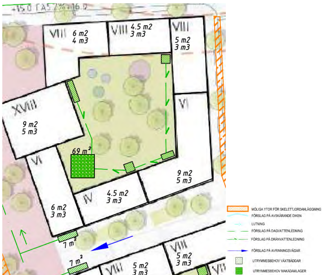
Figur 24: Exempel på placering av växtbäddar, makadamlager, dräneringsledningar och avrinningsvägar. Fastigheternas fördröjningskrav och växtbäddarnas utrymmesbehov redovisas på varje fastighet (För krav på mängd växtbäddar och makadam se Bilaga 1 och för föreslagen utformning se Bilaga 6)
