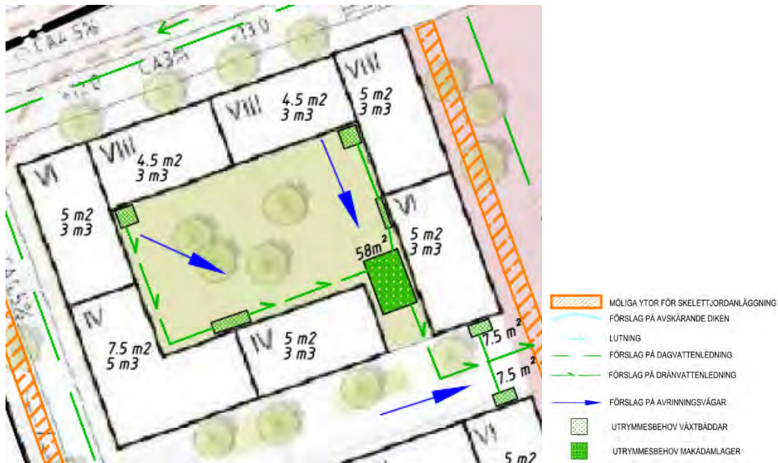
Figur 22: Exempel på placering av växtbäddar, makadamlager, dräneringsledningar och avrinningsvägar. Fastigheternas fördröjningskrav och växtbäddarnas utrymmesbehov redovisas på varje fastighet (För krav på mängd växtbäddar och makadam se Bilaga 1 och för föreslagen utformning se Bilaga 6)
