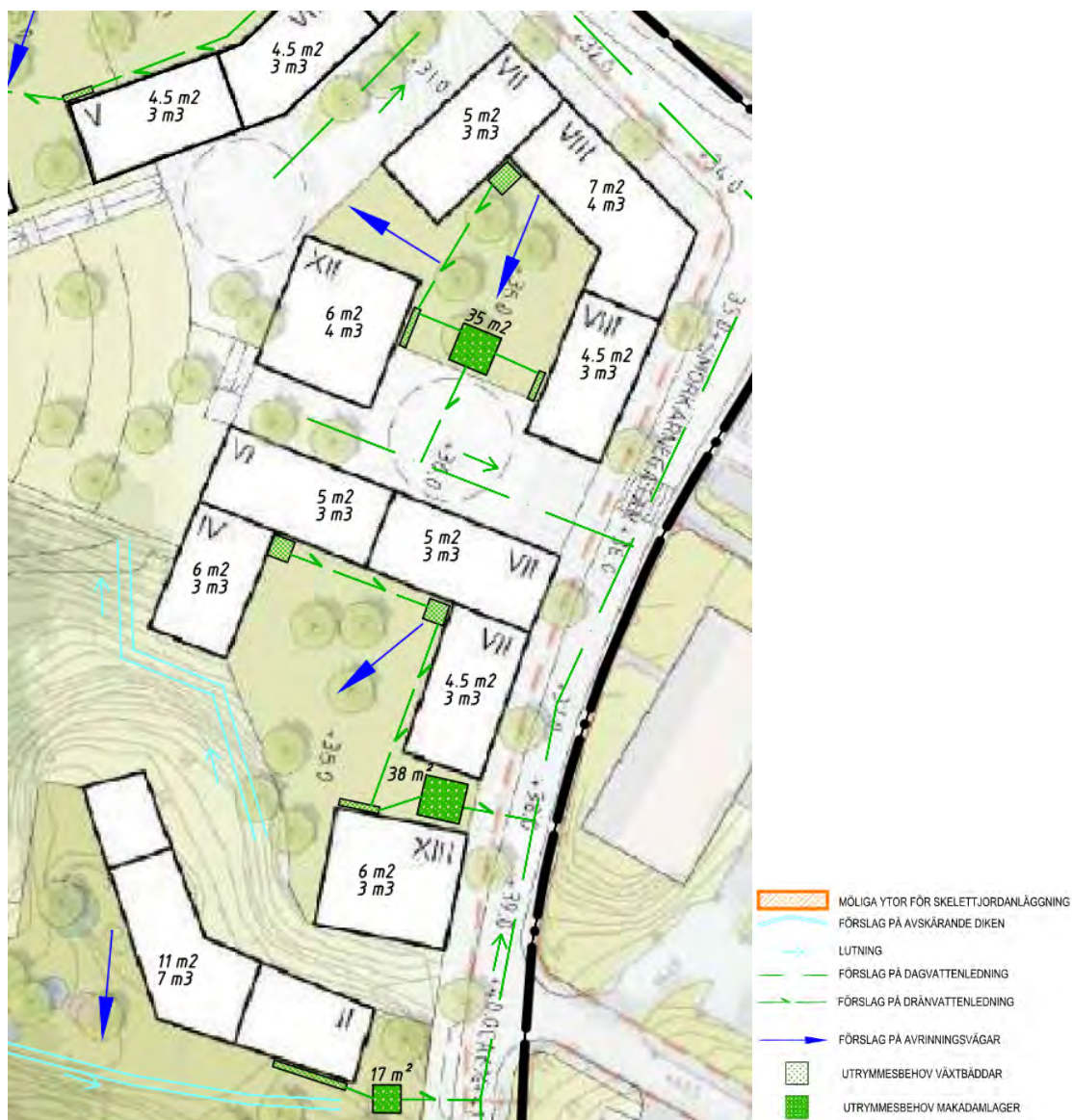
Figur 28: Exempel på placering av växtbäddar, makadamlager, dräneringsledningar och avrinningsvägar. Fastigheternas fördröjningskrav och växtbäddarnas utrymmesbehov redovisas på varje fastighet (För krav på mängd växtbäddar och makadam se Bilaga 1 och för föreslagen utformning se Bilaga 6)
