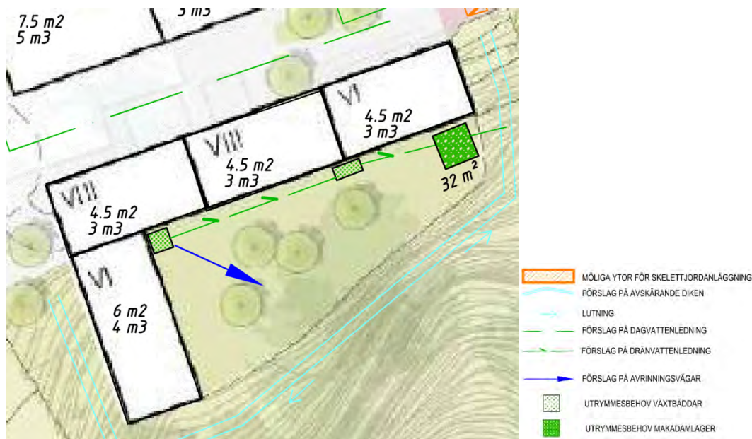
Figur 23: Exempel på placering av växtbäddar, makadamlager, dräneringsledningar och avrinningsvägar. Fastigheternas fördröjningskrav och växtbäddarnas utrymmesbehov redovisas på varje fastighet (För krav på mängd växtbäddar och makadam se Bilaga 1 och för föreslagen utformning se Bilaga 6)
