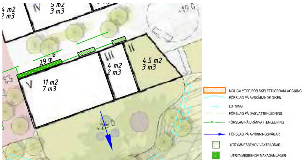
Figur 26: Exempel på placering av växtbäddar, makadamlager, dräneringsledningar och avrinningsvägar. Fastigheternas fördröjningskrav och växtbäddarnas utrymmesbehov redovisas på varje fastighet (För krav på mängd växtbäddar och makadam se Bilaga 1 och för föreslagen utformning se Bilaga 6)
