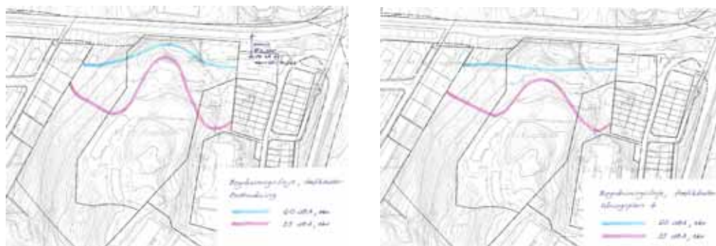
Bullerbedömning gjort av planerare på stadsbyggnadskontoret i nivå med bottenvåning och plan 4
