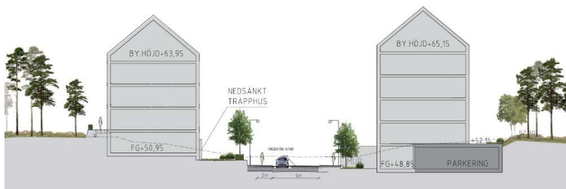
Sektion genom nya bostadshus söder om fd bostadshuset för läkare och sjuksköterskor. (Liljewall arkitekter)
