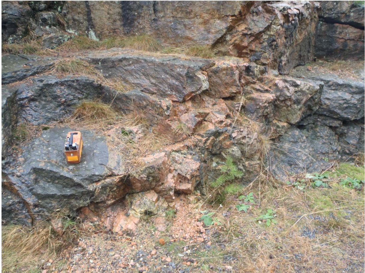
Foto 4. Ögonförande granit med gång/lins av tätt uppsprucken pegmatit. Det uppspruckna materialet faller lätt ut, som i nedre delen av bilden. Bilden tagen vid Rudolf Steiner-skolans nordvästra hörn.
