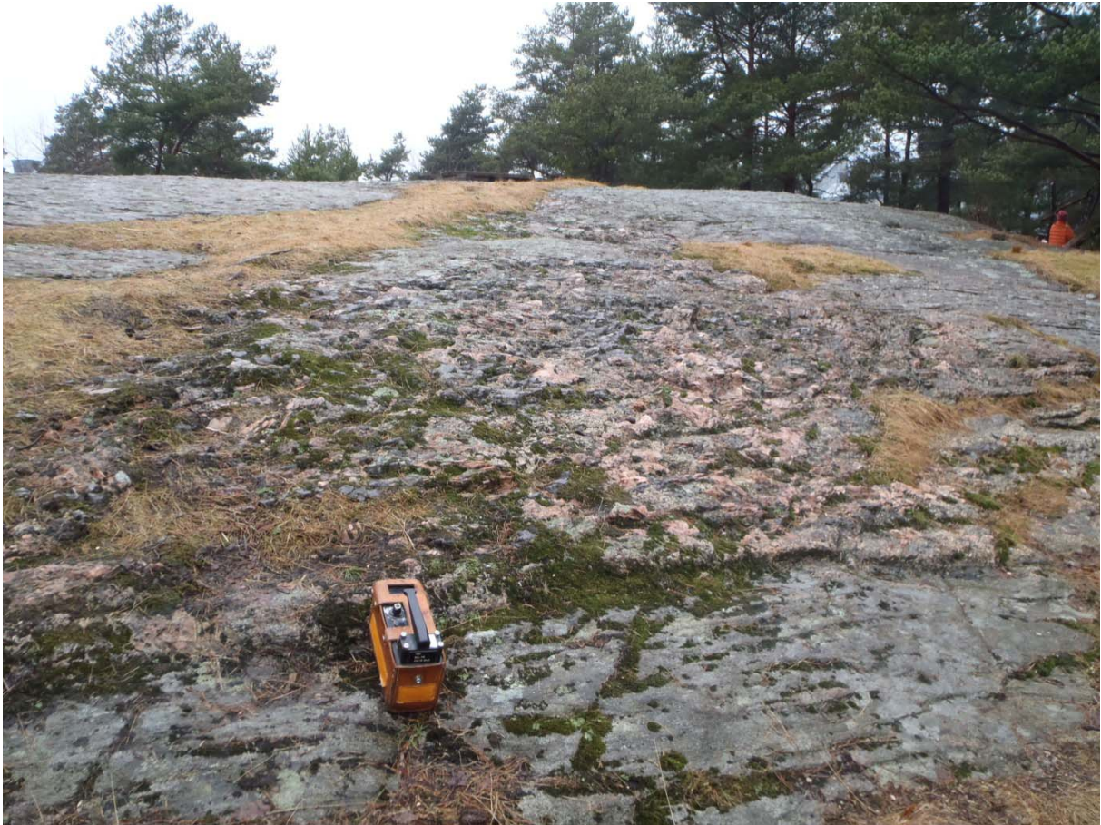
Foto 3. Flack, rundad häll uppe på det nordligaste höjdområdet. Scintillometern står på kontakten mellan ögonförande granit till gnejs (nedanför instrumentet) och tätt uppsprucken pegmatit (ovanför instrumentet). Linser/kroppar av pegmatit som den här förekommer på flera ställen och detekteras lätt med hjälp av sina något förhöjda gammastrålningsnivåer.
