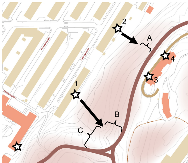
Figur 7.3. Måttangivelser vid beräkning av bullernivåer vid olika avstånd från vägmitt.
