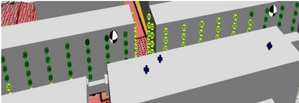
Figur 24: Beräknade nivåer på fasad (västra) hus 12 och 16, nattetid efter åtgärder.
