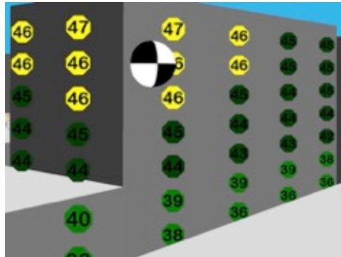
Figur 13: Beräknade nivåer på fasad (norr och väst) dagtid innan åtgärder för hus 15
