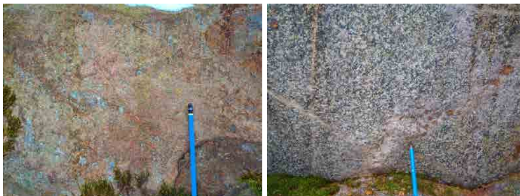
Figur 3.2: Förekommande bergarter i delområde 2. Till vänster ljus röd granit, till höger gabbro till diorit med högt plagioklasinnehåll.
