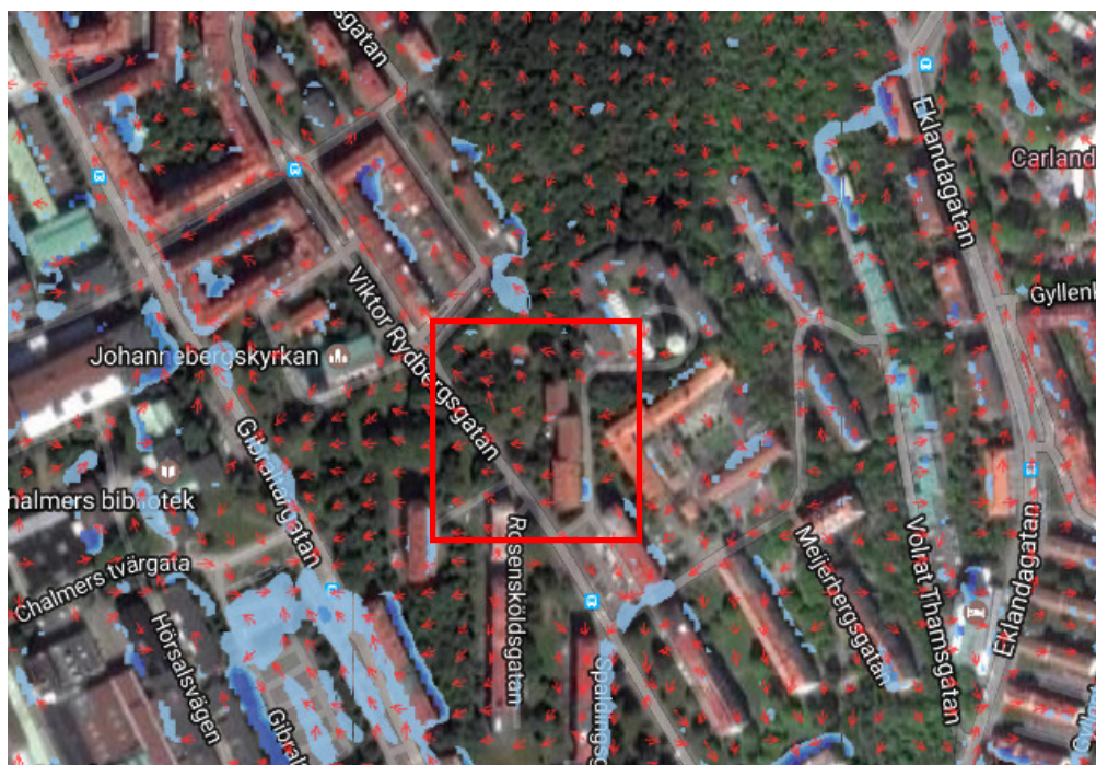
Figur 4: Skyfallsmodellering för befintligt förhållande vid 100-årsregn. Stora röda pilar visar uppskattat flödesriktning i området.
