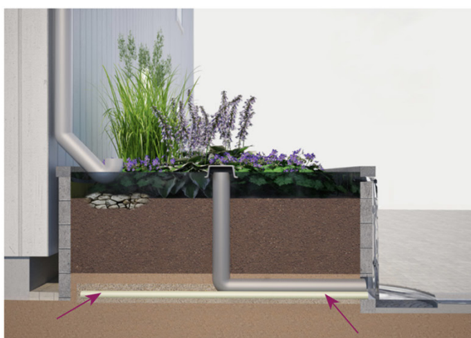
Figur 11: Upphöjd regnbädd med översvämningskydd, bräddavlopp och dränering. Movium Faktablad, 2015
