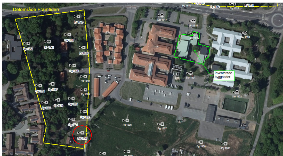
Utsnitt bilaga 1, kompletterade miljötekniskutredning, Sweco 2018. Provgrop där halt av zink överskrider rekommenderad haltgräns för farligt avfall markerad med röd ring.
