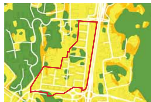
Stabilitetskarta; grönt - fastmark, gult - sekundärscred kan uppkomma, orange - förutsättningar för initialscred.
