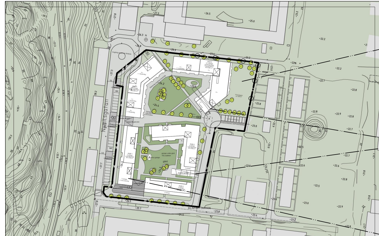
Situationsplan, Föreslagen byggnader illustreras vita. Befintliga byggnader illustreras gråa. Skala 1:1000 (A1) Skala 1:2000 (A3), Arkitektbyrån Design och Kirsh + Dereka Arkitekter
