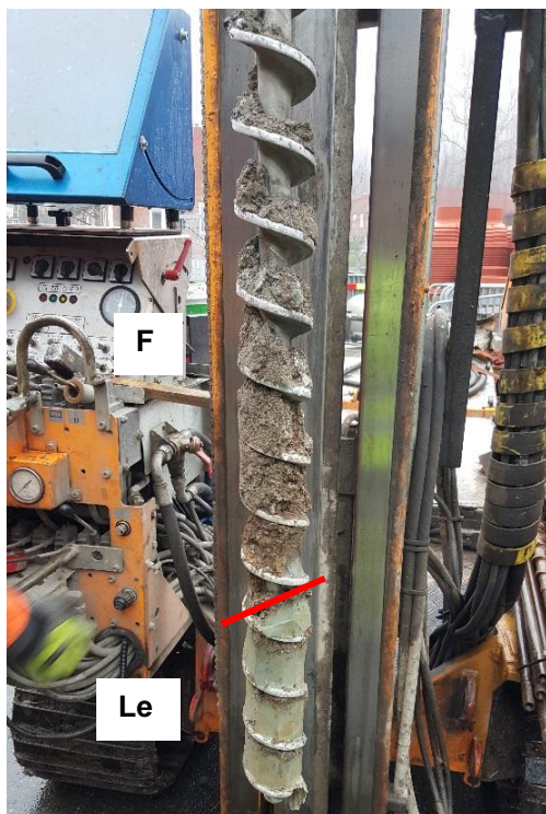
Figur 8. Typiska fyllnadsmassor från Skr1506 (0,05-0,7 m). Röd linje markerar övergången från fyllnadsmaterial till naturligt bedömd lera.
