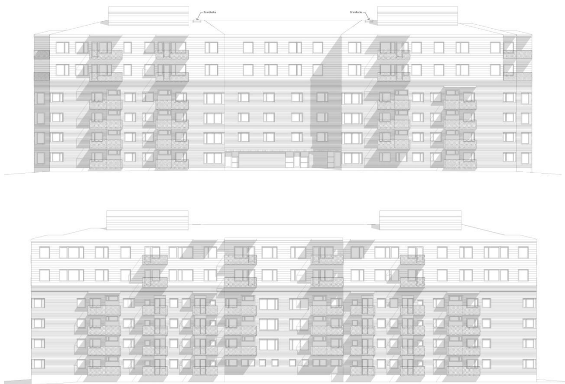
Fasadritningar som visar balkongplacering och övergång mellan nytt och gammalt. Överst fasad mot väster och underst fasad mot öster. (Bild från Abako)
