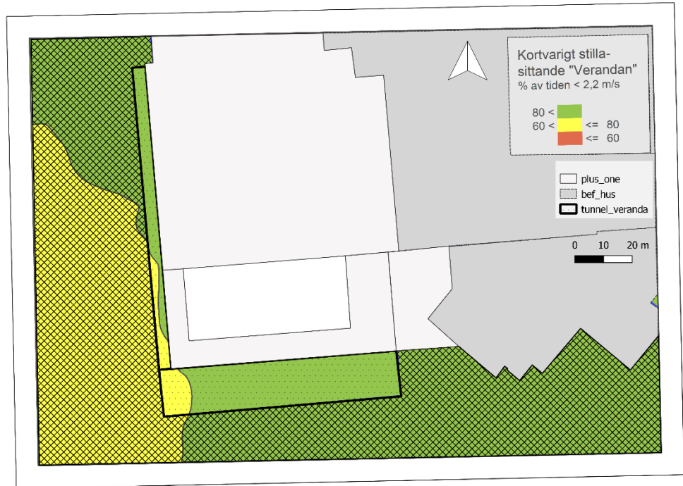
Figur 11 Vindkomfort för kortvarigt stillasittande på verandan (prickigt område). Resultatet visar antal timmar (i %) under ett år där vinden är <2,2 m/s på en höjd mellan 12 – 24 meter över markplan. Färgerna motsvarar klassifikationen i Tabell 4.
